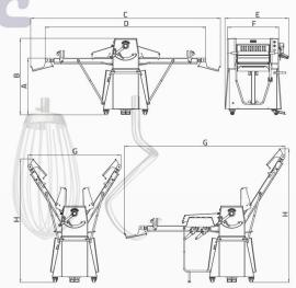
Per il modello SHE6014DT (cioè con piani di lunghezza 1400 mm e dispositivo di taglio) è possibile mettere solamente il piano destro in posizione di riposo (come riportato in figura). Per il modello SHE6016DT non è consentita posizione di riposo.
