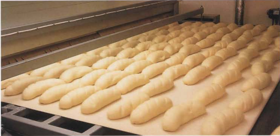
已醒发的产品在醒发线和隧道烤炉之间输送。
